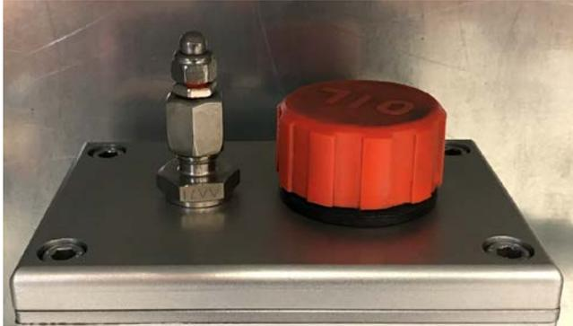
Abb. 1 Füllstandsanzeige leer
